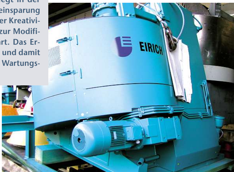
Bild 1: Großmischer, bei dem der Behälter für Wartungs- und Reinigungsarbeiten manuell in Position gedreht wird. Das geschieht per Hand über die Motorwelle.
