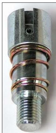
Bild 2: Aus einem Winkelgelenk gefertigter Adapter. Er ermöglicht das Drehen der Motorwelle mit Hilfe eines Drehmoment-schlüssels.
