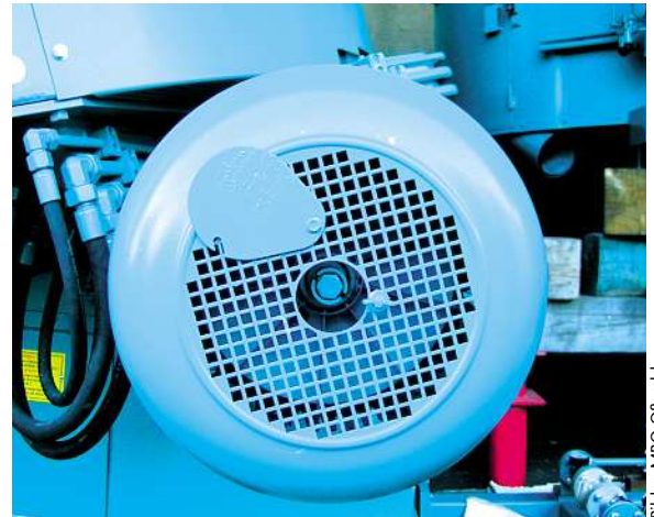
Bild 3: Zum Drehen der Motorwelle wird ein Momentschlüssel auf den Sechskant des Adapters gesteckt. Dabei muss der Lüfterschutz nicht abgenommen werden.
